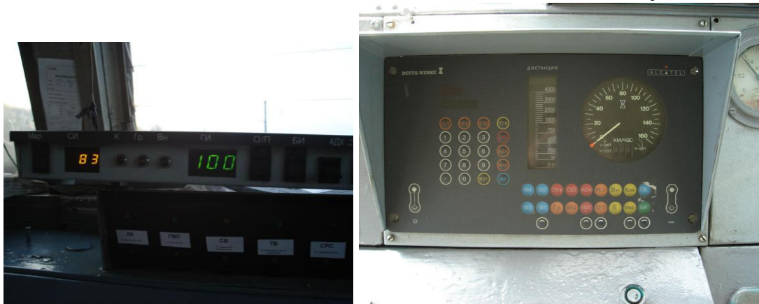
Фиг. 5 и 6. Бордово оборудване на система АЛС в БДЖ.
